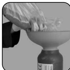
Trichter auf leere Patrone aufsetzen und neues Harz einfüllen.
