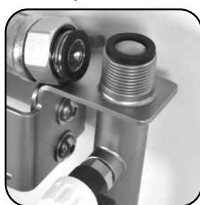
Le tamis de sécurité livré avec l'appareil empêche le passage des résines en cas de dégradation dans la cartouche échangeuse d'ions. Posez le tamis de sécurité sur le filetage  $\frac{3}{4}$ " à la sortie de la robinetterie de raccordement avant d'installer le robinet à boisseau sphérique.
