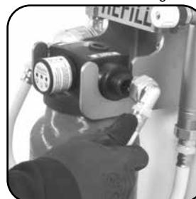
Anschlussnippeln in die Haltebügel. Drehen Sie die Patrone dann in eine senkrechte Position.
