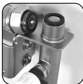
Das im Lieferumfang enthaltene Sicherheitssieb verhindert einen Durchbruch der Harze im Falle einer Beschädigung in der Ionenaustauscherpatrone. Legen Sie das Sicherheitssieb vor Montage des Kugelhahn auf die 3/4" Verschraubung am Auslauf der Anschlussarmatur.
