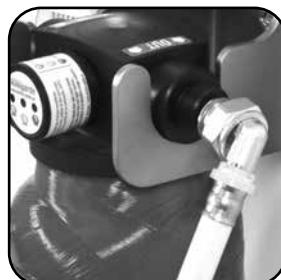
Anschlussverschraubung lösen. Patrone aushängen.
