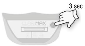
Der Dauermodus wird durch ein längeres drücken (etwa 3 Sekunden) der F-Taste aktiviert. Die Aktivierung wird mit drei aufeinanderfolgenden akustischen Signalen bestätigt. Die Status-LED bleibt bis zur Deaktivierung dauerhaft aktiv. In diesem Modus bleibt die Messung und Anzeige dauerhaft aktiv. Zur Deaktivierung muss erneut die F-Taste länger gedrückt werden. Die Deaktivierung wird ebenfalls akustisch bestätigt. Der Dauermodus wird nur bei einer Spannungsversorgung mit Netzteil empfohlen.
