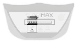
Der erste Bereich ist in 4 grüne LEDs eingeteilt. Die LEDs gehen nacheinander an, bis alle 4 LED aktiv sind. Sie signalisieren eine zunehmende Erschöpfung der Filterkartusche. Die Wasserqualität befindet sich innerhalb der Empfehlungen der VDI 2035.
