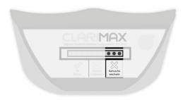
Der dritte Bereich ist in 3 rote LEDs eingeteilt. Die LEDs gehen alle gleichzeitig an und blinken. Gleichzeit ertönt ein Warnsignal. Die gelben LEDs gehen aus. Die Filterkartusche ist erschöpft und muss ausgewechselt werden. Die Wasserqualität entspricht nicht mehr den Empfehlungen der VDI 2035.
