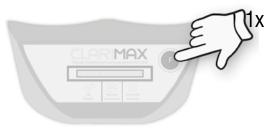
Der Intervallmodus wird durch einen einfaches drücken der F-Taste aktiviert. Die Status-LED blinkt während der aktiven Zeit. In diesem Modus bleibt die Messung und Anzeige für 30 Sekunden aktiv. Anschließend wird Sie wieder deaktiviert und befindet sich im Standby. Dieser Modus dient der Energieeinsparung und wird für den Akku-Betrieb empfohlen.
